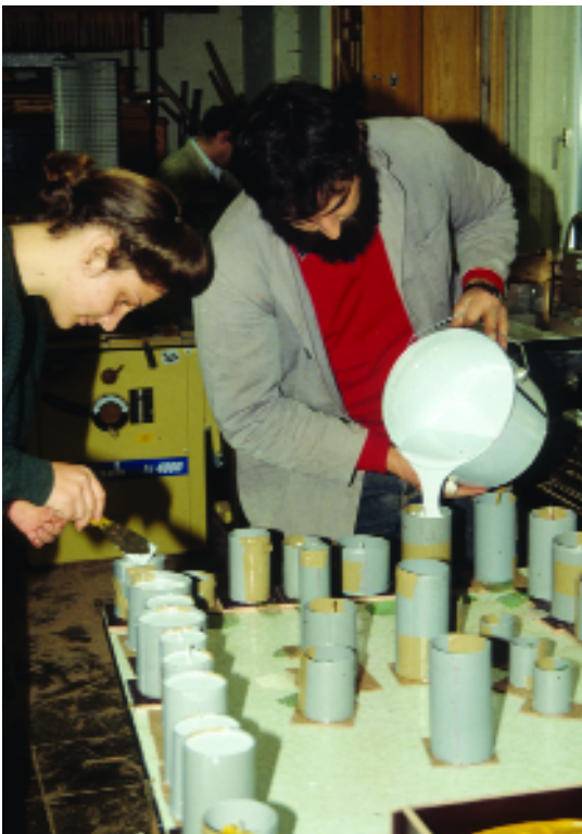
▲ Die gut gemischte Silikonmasse wird in die vorbereiteten Formen gegossen. Sobald die Vorlage überdeckt ist, wird das Kunststoffgitter eingelegt und dann aufgegossen.
