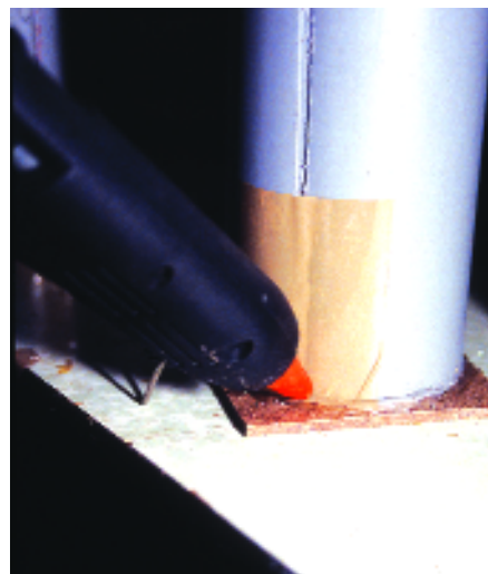
Für die Herstellung einer Form benötigt man eine Modell-Vorlage, Brettchen, Kunststoffrohr und Kunststoffgitter.
