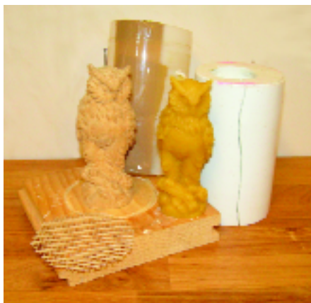
Für die Herstellung einer Form benötigt man eine Modell-Vorlage, Brettchen, Kunststoffrohr und Kunststoffgitter.
